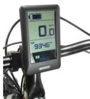
Am Lenker montiertes Display
