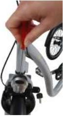
Drehen Sie die Inbus-Schraube auf
