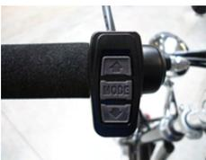
Am Lenker montierte Bedienelemente
