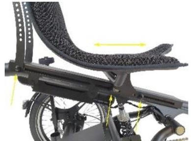
Die Höhe des Sitzes ändert sich automatisch mit, wenn die Sitztiefe eingestellt wird, da das Befestigungsrohr nach oben geneigt ist. Wenn die Sitztiefe richtig eingestellt ist, stimmt auch die Sitzhöhe automatisch. Mit dem Sitz in der richtigen Position strampeln Sie mühelos die Kilometer ab.
