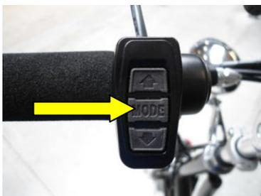
Den Taster **MODE** mind. 3 Sekunden lang drücken, bis das Display aktiv wird. Dann den Taster wieder loslassen. Das längere Drücken dient der Sicherheit gegen unbeabsichtigtes Einschalten. Das System ist nun fahrbereit.
