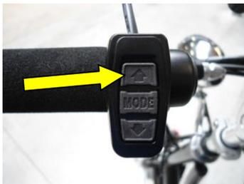
Die Anfahrhilfe ermöglicht Ihnen das Anfahren mit elektrischer Unterstützung ohne zu treten bis zu einer Geschwindigkeit von max. 6km/h.
