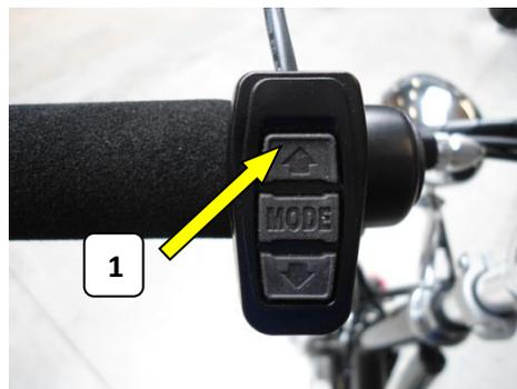
Mit der Mode Taste (3) wird die Trethilfe ein- oder ausgeschaltet. Das Einschalten des Systems erfolgt durch Eindrücken der Mode Taste für 3 Sekunden.
