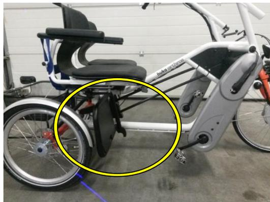
Fußplatte klappbar (nach oben)
