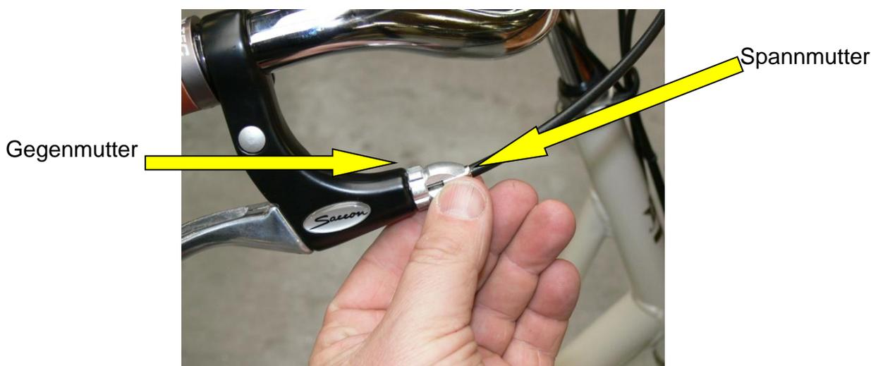
Sie können die Spannmutter an dem Bremsenhandgriff nach außen drehen, um das Bremskabel etwas anzuspannen. Anschließend können Sie diese Position sichern, indem Sie die Gegenmutter wieder an die Spannmutter festdrehen und feststellen.
