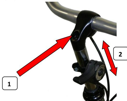
1. Drehen Sie mit einem Sechskantsteckschlüssel Maß 6 den Vorbaubolzen (1) ein wenig lose, sodass die Lenkstange sich verschieben lässt.
