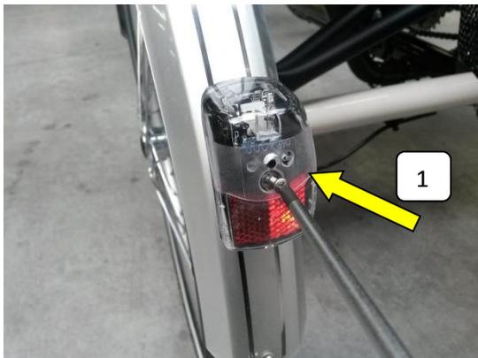
*Drehen Sie an der Kreuzschlitzschraube bis sie sich löst*
