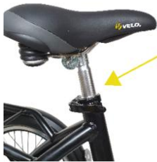
Sitzhöhe über Schnellspannhebel
